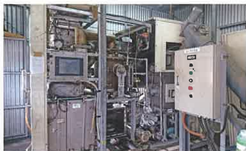
↑ スチレン油を生成する油化装置
