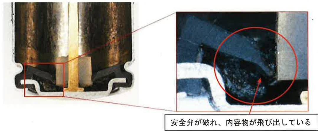
【液漏れした状態のアルカリ乾電池】
